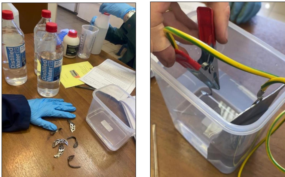
Рис. 2. Анодирование титана, элементы броши. Работа над творческим проектом, 2021
