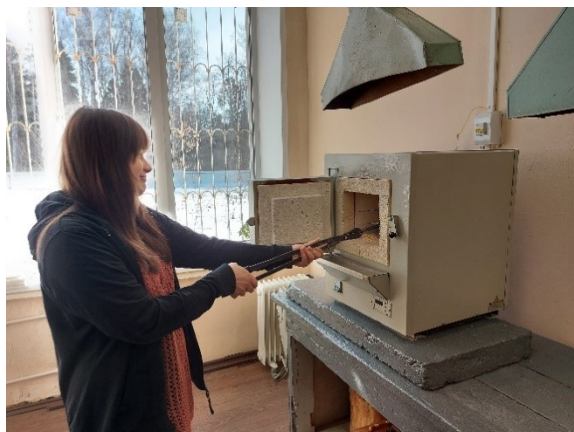
Рис. 7. Обжиг эмалевой пластины
