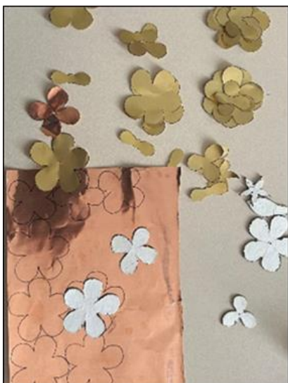
Рис. 1. Шаблоны металлических заготовок для лепестков цветка «роза»
