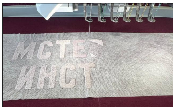
Рис. 4. Процесс вышивания на вышивальной машине Brother
