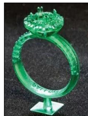
Рис. 8. Модель ювелирного изделия, распечатанная на 3D-принтере
