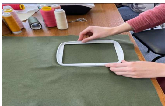
Рис. 3. Закрепление ткани в пяльцах
