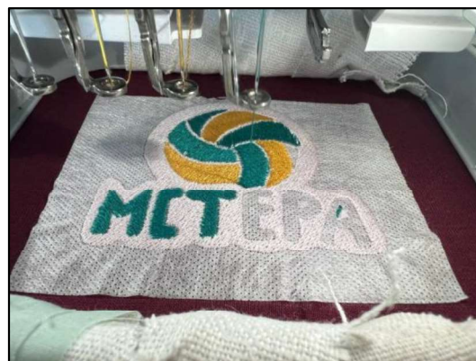
Рис. 2. Процесс вышивания на вышивальной машине Brother
