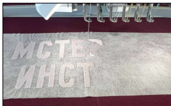
Рис. 4. Процесс вышивания на вышивальной машине Brother
