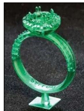
Рис. 8. Модель ювелирного изделия, распечатанная на 3D-принтере
