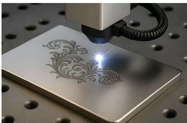
Рис. 10. Использование векторных изображений в гравировальных лазерных машинах
